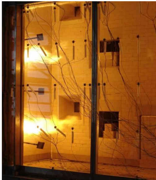
Prüfung nach 7 min 30 sek. Ofentemperatur ca 680°C
